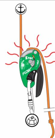
Todos os descensores **FLOW** possuem a característica COL – novo conceito (Climb on Lock). Esta característica permite que o dispositivo pode ser ajustado ou usado para subir com a alavanca de controle na posição travada.
